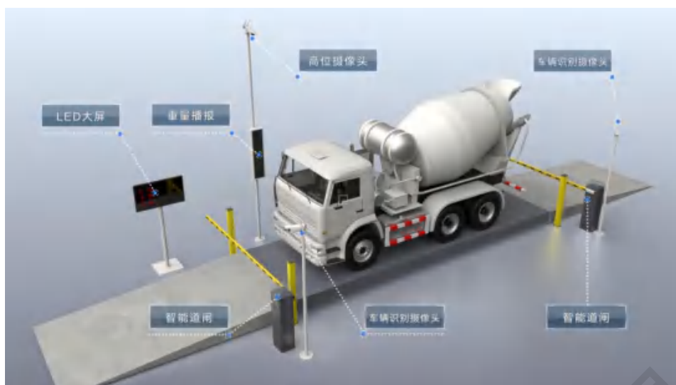
图 2 智慧物料系统硬件布置
