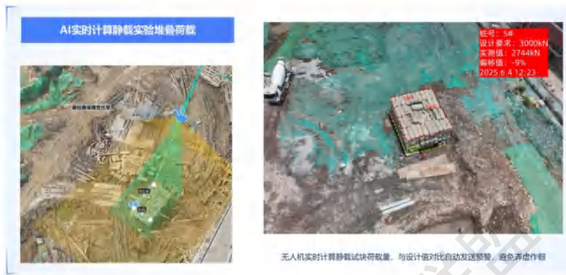
图 7 联动巡检-桩基检测
