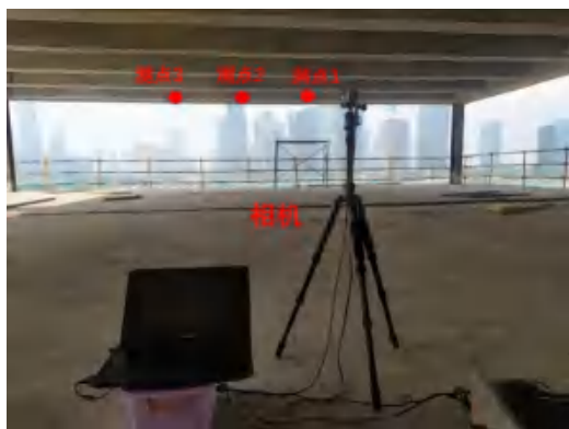
图 8. 相机及测点布置
