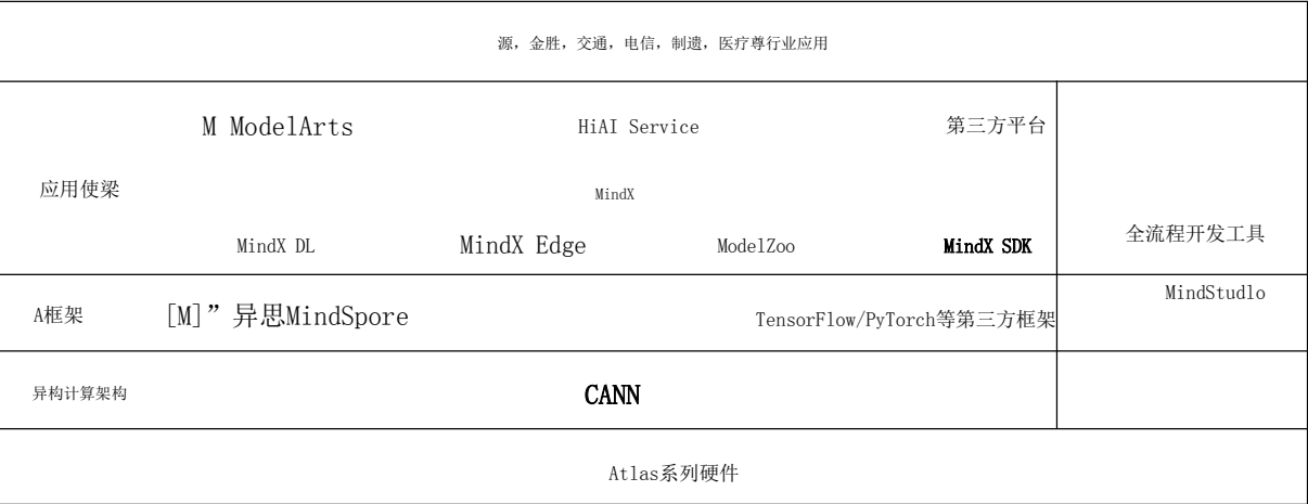
图34昇腾全栈AI软硬件平台 资料来源：昇腾官网
